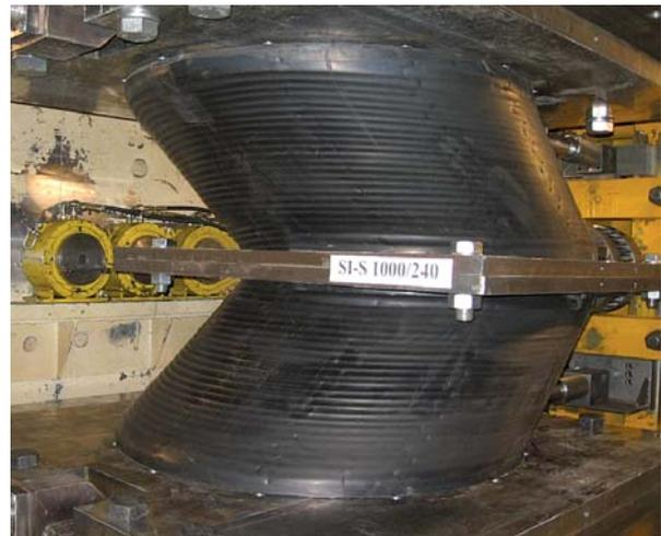
Prove di accettazione di una coppia di isolatori sismici HDRB presso i laboratori della **FIP Industriale**
